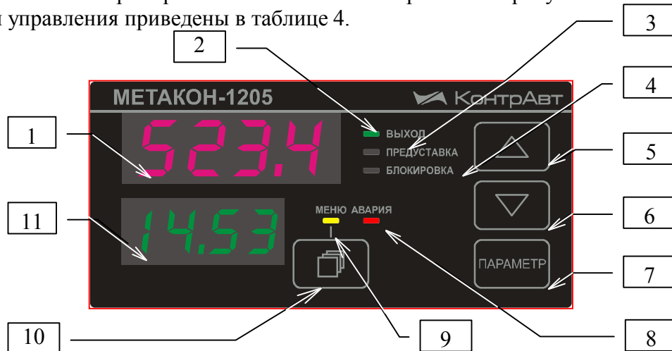
Рисунок 1 - Передняя панель прибора МЕТАКОН-1205
